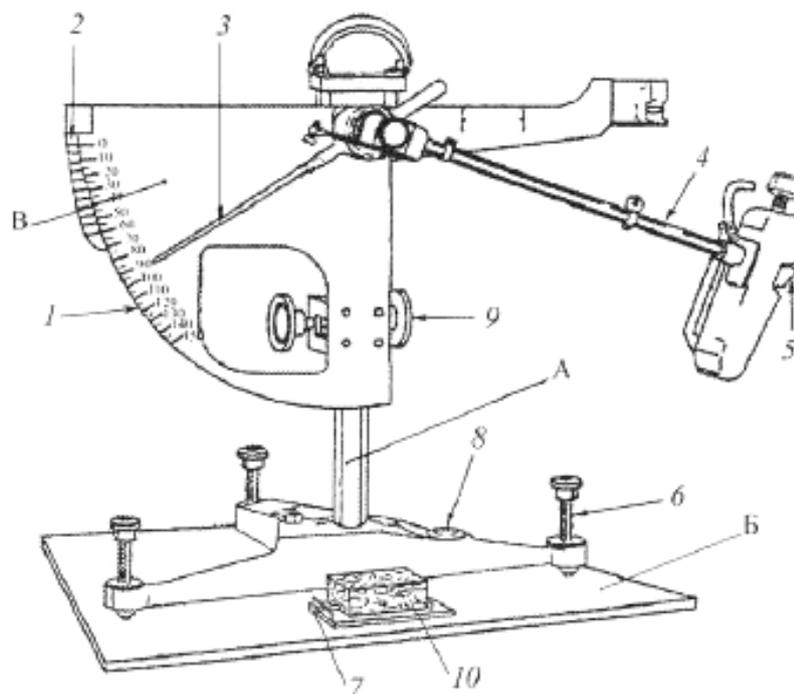
А – стойка; Б – плита-основание; В – сектор с круглыми шкалами 1 и 2; 3 – стрелка-указатель; 4 – плечо маятника; 5 – ползун с резиновым вкладышем; 6 – регулировочные винты; 7 – замки для фиксации образца; 8 – уровень; 9 – винт крепления сектора к вертикальной стойке; 10 – испытываемый образец
